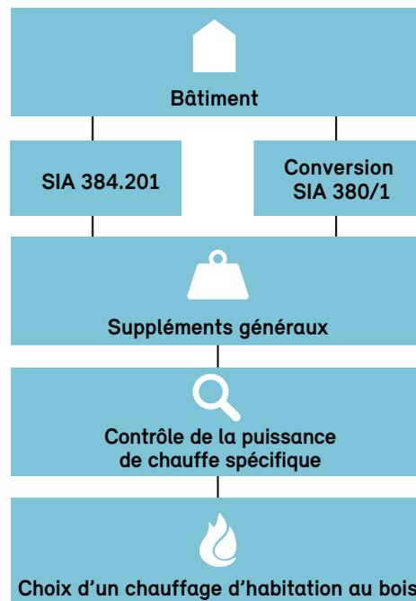
Procédure pour le dimensionnement d'un chauffage d'habitation au bois. Source: SuisseEnergie
